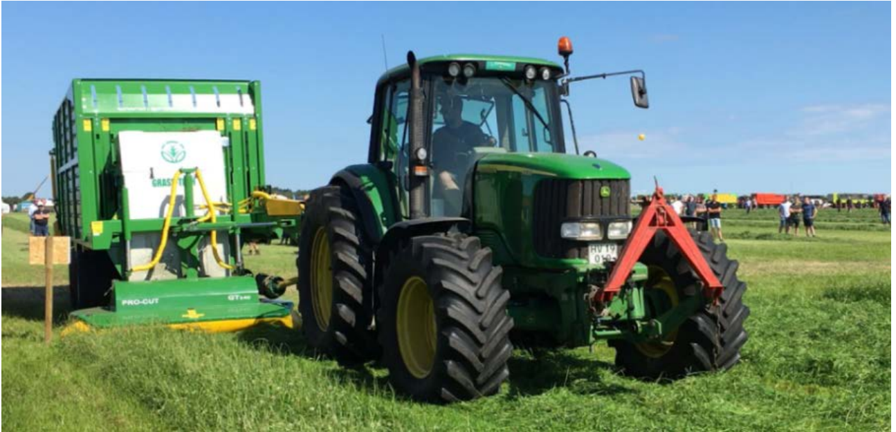
Figur 1: Skårlægger med opsamling i en og samme arbejdsgang demonstreret på Græsland18.
